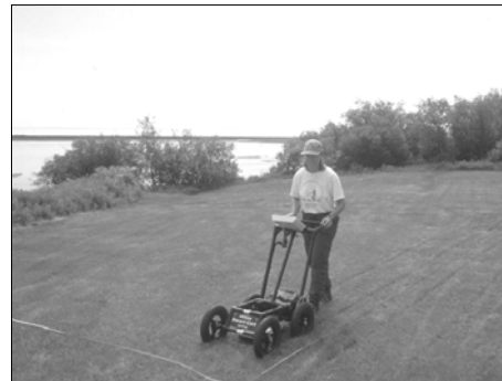
Utilisation d'un géoradar à York Factory. (R. Heitzmann)
