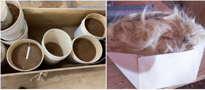
Gauche : Sable utilisé dans le mélange de plâtre traditionnel. Droite : Crin de chèvre utilisé dans la première couche de plâtre
