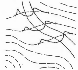
Fig. 3.2. Lorsqu'on présente les courbes existantes et celles qui sont proposées, il devient plus facile de visualiser les conséquences des travaux de déblai et de remblai.
