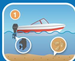
1. Le bateau est utilisé sur un plan d'eau contenant des moules zébrées. Des larves véligères s'y introduisent.
