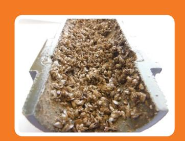
Conduite de prise d'eau obstruée par des moules
