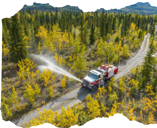
Un camion-pompe de la Section de la gestion des feux de forêt du gouvernement du Yukon mouille les matériaux combustibles adjacents.
